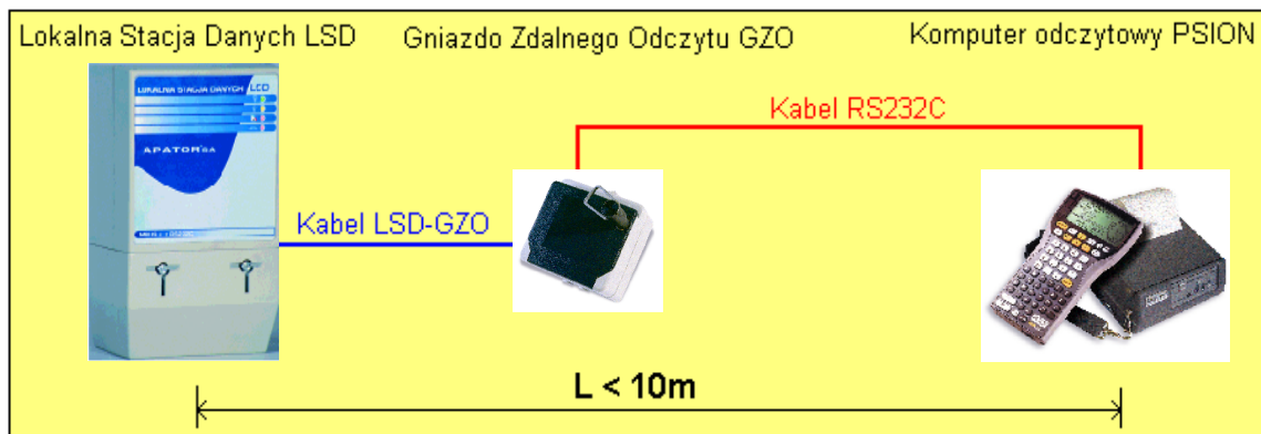
Rys. 16 Maksymalna długość połączeń LSD-GZO-PSION
